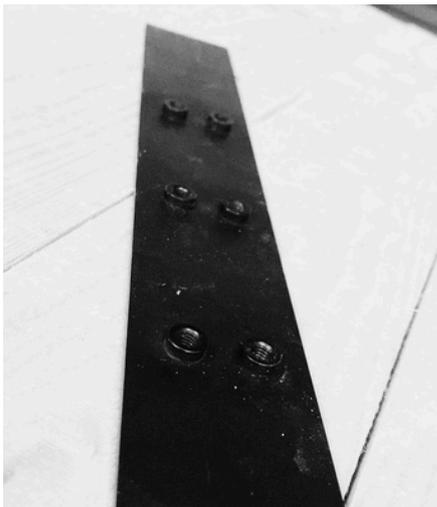
Stap 2: Plaats tegelijkertijd het isolatieplaatje op het opzetkantje boven de deur tegen de binnenwand van de branderkamer
