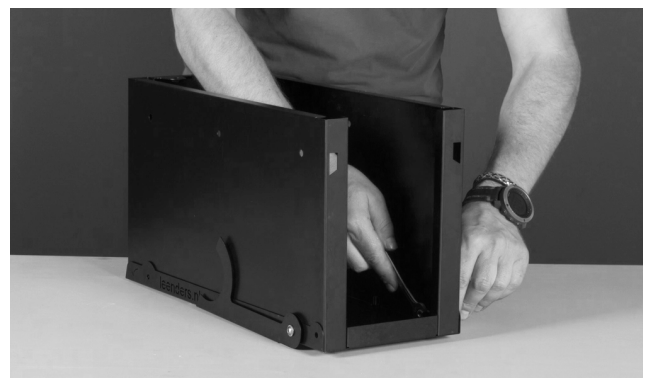
Ständer Vorderseite 6 montieren (2x Schraube + 2x Sicherungsmutter) Sicherungsmuttern nicht zu stark anziehen, der Ständer muss bewegen können.
